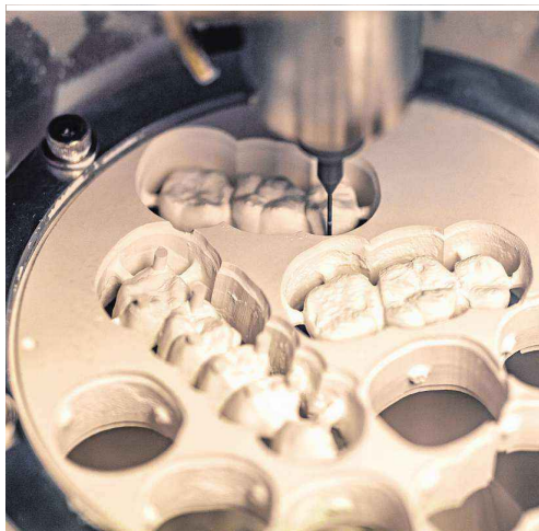
Hightech ist in der Zahnmedizin heute selbstverständlich. Mit der sogenannten CAD/CAM-Technologie können jegliche Zahnersatzteile präzise designt und anschließend aus modernsten Materialien gefräst werden
