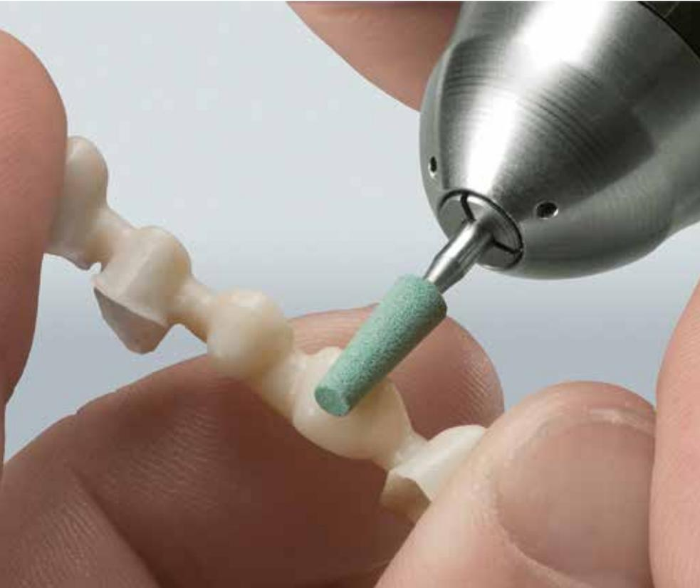
**2** Die spezielle Bindung und der hohe Anteil an Diamantkörnern sorgen dafür, dass sich mit den DCB-Schleifern hochfeste Keramiken wie Zirkonoxide ohne hohen Druck effizient bearbeiten lassen.
