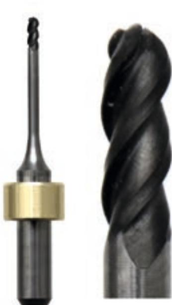
**1** Die Fräswerkzeuge sind mit drei statt zwei Schneiden ausgestattet, was einen höheren Vorschub ermöglicht
