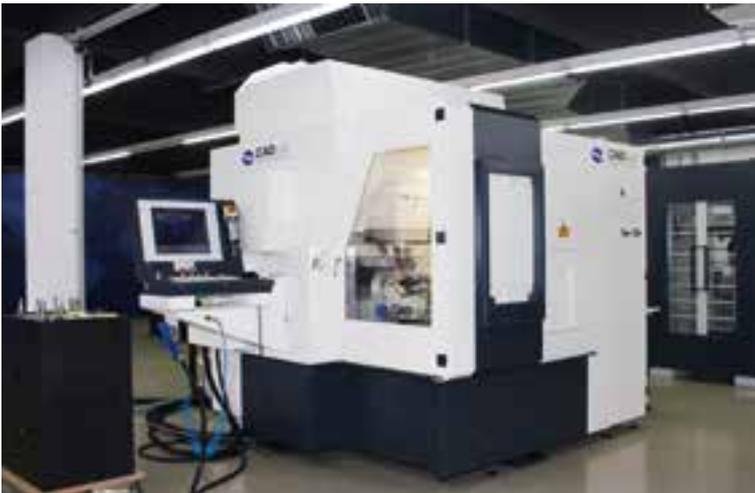
Die neueste HSC Maschine im CADstar Produktionszentrum verfügt über eine Spindellängenkompensation für noch höhere Genauigkeit
