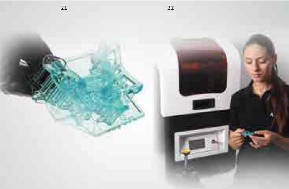
**21 & 22** Die Bohrschablone wird unmittelbar nach dem 3D-Druck dem Varseo entnommen und danach vom Stempel gelöst
