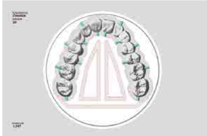
2 Zenotec CAM-Ansicht mit Sinterrahmen
