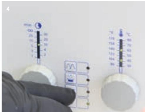
**4** Das Abutment wird in dieser Reinigungsflüssigkeit bei 60°C zehn Minuten lang im Ultraschallgerät gespült
