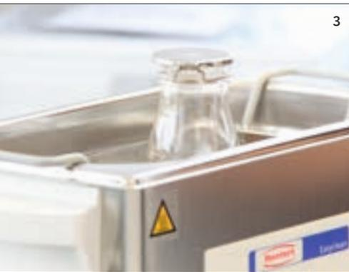
**3** Der individuell gefertigte Implantataufbau wird in einer antibakteriellen Reinigungsflüssigkeit im Ultraschallbad gereinigt
