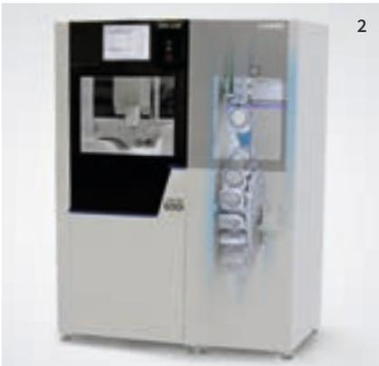
**2** Die vollautomatische 5-Achs-Fertigungsmaschine 650i kann optional mit einem vollautomatisierten Materialwechsler ausgestattet werden
