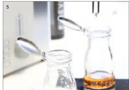
**5** Nach zehn Minuten wird das Abutment in 96%igen Ethylalkohol gegeben und erneut bei 60°C für zehn Minuten ...
