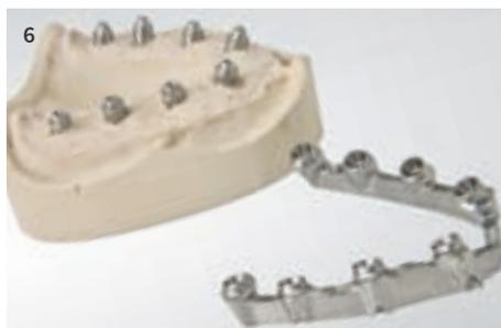
**5 & 6** Mit der 650i und einer entsprechend hochwertigen, vorgeschalteten Prozesskette ist man in der Lage, selbst komplizierte dentale Strukturen auf höchstem Niveau zu fräsen. Herauszustellen ist die sehr konstante Präzisions-Wiederholbarkeit im µm-Bereich. Diese Präzision weist die Maschine als professionelles System für komplexe Strukturen aus
