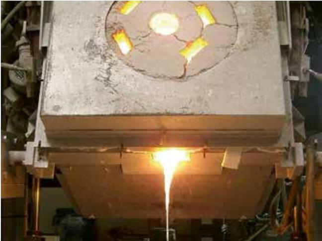
Herstellung von Glaskeramik: Die flüssige Glasmasse wird zur Abkühlung in ein Wasserbecken gegossen.
