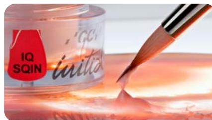
^ 12 Ein spezielles Form- und Textur-Liquid verleiht der Keramik eine beinahe plastische Konsistenz, die hohe Standfestigkeit ermöglicht eine zielgerichtete Formgebung.
