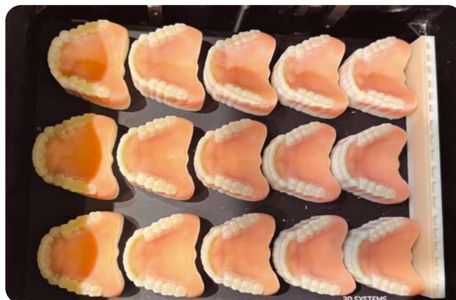
^ 22 Laut Hersteller können mit dem NextDent 300 MultiJet 15 Prothesen in einem Bauprozess gedruckt werden. Die Bauzeit liegt bei ca. neun Stunden.
