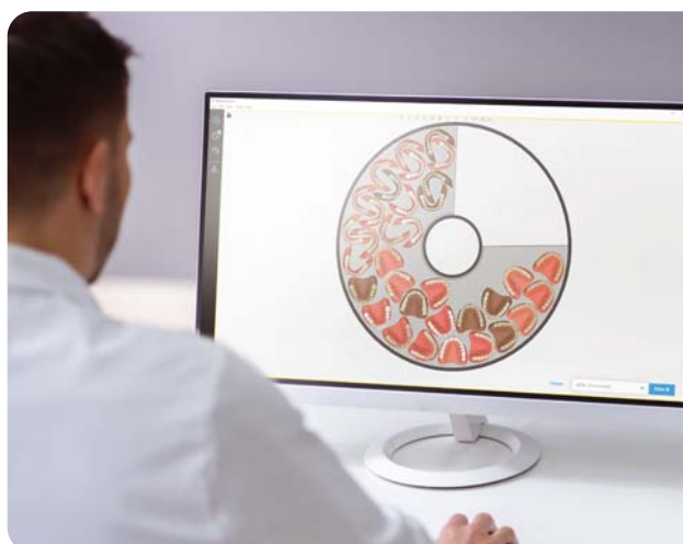
^ 24 Mit dem J5 DentaJet Drucker können mehr als 30 vollmonolithische, mehrfarbige Prothesen pro Druckauftrag hergestellt werden.
