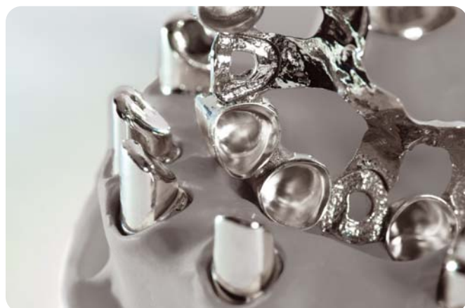
^ 28/29 Bego Wironium Hybrid RP (digitaler Hybridmodellguss mit Teleskopen). Die Fertigung erfolgt als Kombination aus selektivem Lasermelting (SLM) und Hochgeschwindigkeitsfräsen (HSC).
