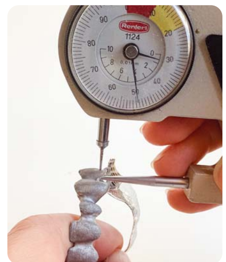
^ 34 Die Wandstärke von Fidentis Doppelkronen liegt bei ca. 0,5 mm.
