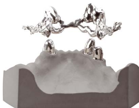
^ 28/29 Bego Wironium Hybrid RP (digitaler Hybridmodellguss mit Teleskopen). Die Fertigung erfolgt als Kombination aus selektivem Lasermelting (SLM) und Hochgeschwindigkeitsfräsen (HSC).
