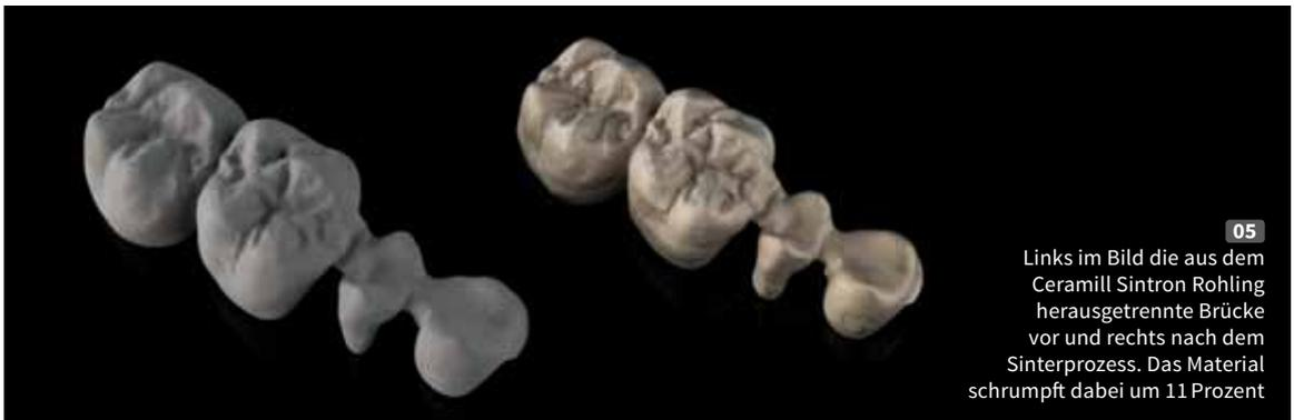
**05** Links im Bild die aus dem Ceramill Sintron Rohling herausgetrennte Brücke vor und rechts nach dem Sinterprozess. Das Material schrumpft dabei um 11 Prozent
