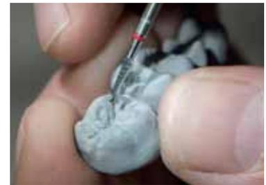
**03 + 04a** Erster Schritt der individuellen Nachbearbeitung nach dem trockenen Fräsen in der Ceramill Motion/Motion2: Mit einem mittels Diamantscheibe zugespitzten (alten) Hartmetallfräser können die Fissuren und weitere Details im Grünlingszustand nachgearbeitet werden
