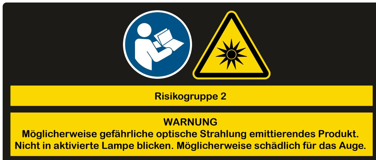
^ 03 Beispiel der Kennzeichnung eines Produktes mit optischer Strahlung der Risikoklasse 2
