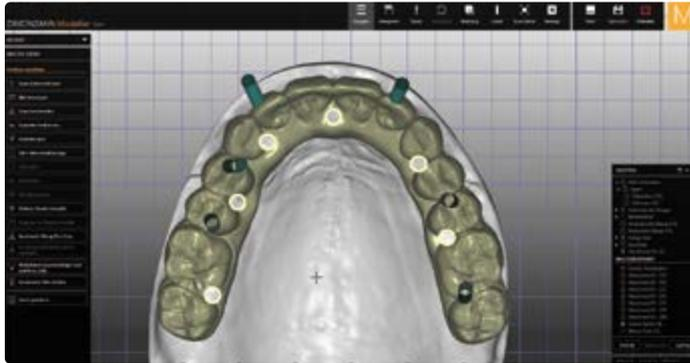
◀ in der Software Zirkonzahn.Modellier ermöglicht die Double Screw Metal Funktion das Generieren von virtuellen Schraubengewinden innerhalb des Stegdesigns.
