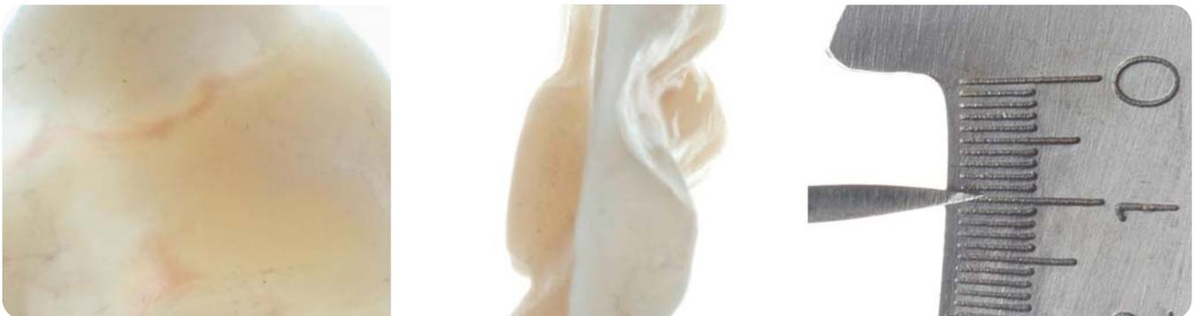
^ 08 Gefrästes 1 bis 1,5 mm dünnes Endo-Overlay, gemessen mit Tasterzirkel nach Iwanson
