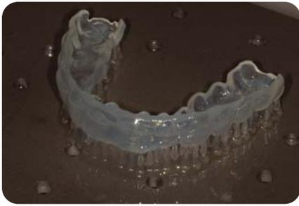
^ 08 Bleaching-Schiene nach dem Druck auf der Bauplattform des Druckers
