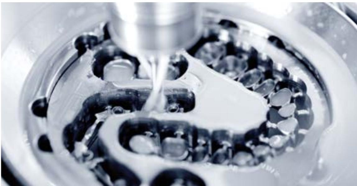
Zirkonzahn bietet nun neben CrCo- auch Titan-Ronden, die unter Nasskühlung mit den Fräsgeräten M1 Wet Heavy und M5 (Kit Wet Grinding/Wet Milling M5 und Milling Spindle Hard Automatic M5) sowie dem CAD/CAM Fräser Titan bearbeitet werden können
