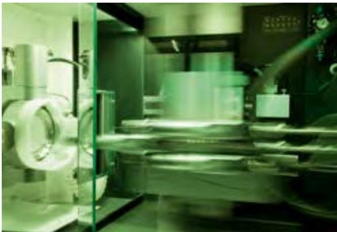
**03** Da die Silent compactCAM speziell für dentale Fertigungsmaschinen (Trockenbearbeitung) konzipiert wurde, weist sie eine optimierte Saugleistung auf. Diese ist mit deutlich größeren Absaugungen vergleichbar. Hier im Bild: die Bearbeitung von Zirkonoxid
